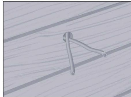
Чтобы просверлить отверстия для освещения, используйте сверло с твердосплавным наконечником.
