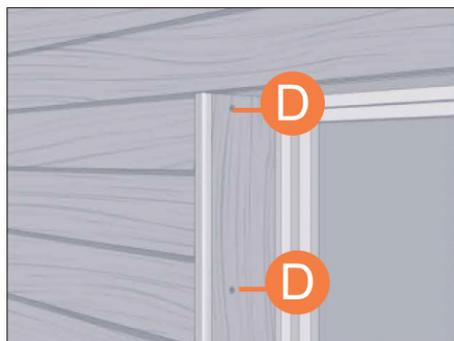
Закрепите доску с помощью гвоздей или саморезов и подкрасьте их. Или используйте саморезы с окрашенными шляпками в цвет материала.
