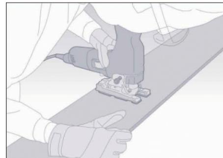
После установки последней доски под окном приложите отлив (не прикрепляя его) и отметьте расположение отлива на доске. Переверните доску и начертите контур подоконника на задней части доски. Оставьте зазор 10 мм между отливом и доской для вентиляции.
