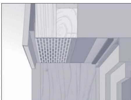
Измерьте глубину оконного откоса, не забывая о зазоре 25 мм для вентиляции. Отпилите необходимую полоску фиброцементного сайдинга в продольном направлении.
