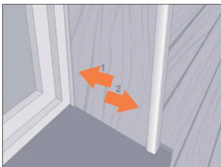
Плавным движением (1) вставьте полоску в соединительный профиль и оттяните назад (2) к угловому профилю.
