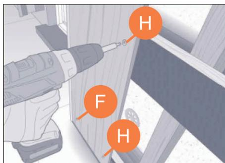
Закрепите нижний ряд досок на каждом бруске. Отступы от края доски – 20 мм. Прикрепите первую доску. Не забывайте, что гвозди или саморезы в углах будут видны, поэтому используйте саморезы с окрашенными шляпками в цвет материала.
