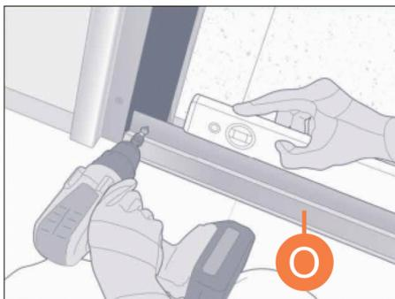
Теперь установите стартовый профиль по периметру фасада на той же высоте, что и низ углового профиля. Очень важно, чтобы стартовый профиль был установлен по уровню.
