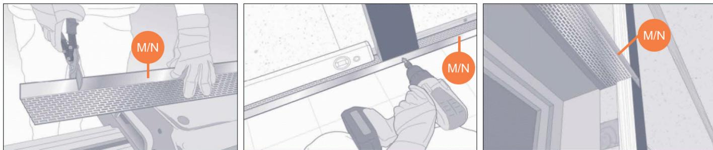
Чтобы предотвратить попадание грызунов и птиц в вентилируемый зазор, установите перфорированный вентиляционный профиль по периметру фасада, над оконными и дверными проёмами. Убедитесь в том, что защищен любой зазор шири 40 мм
