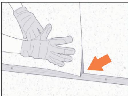
Толщина горизонтальных брусков (при использовании горизонтальных брусков, как указано выше) определяется толщиной утеплителя.
