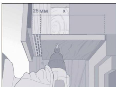
Установите полоску в соединительный профиль и прикрепите её с помощью гвоздей или саморезов, подкрасьте их. Или используйте саморезы с окрашенными шляпками в цвет материала.
