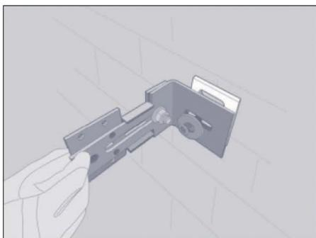
Если требуется установка изоляции большей толщины или если стена неровная, можно использовать регулируемые кронштейны.
