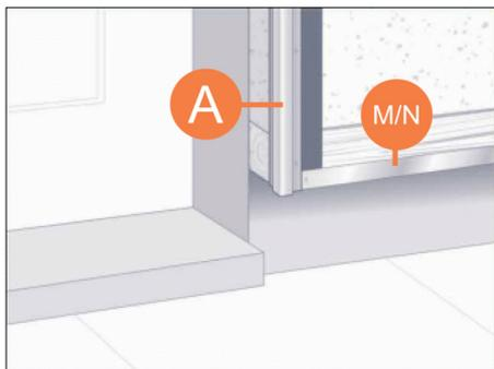
Убедитесь, что низ углового профиля установлен на одном уровне с перфорированным вентиляционным профилем.
