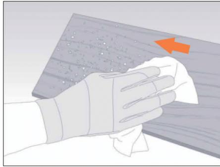
После резки удалите пыль при помощи сухой тряпки из микрофибры и **НЕ ДОПУСКАЙТЕ ПОПАДАНИЯ ВЛАГИ НА ЦЕМЕНТНУЮ ПЫЛЬ!**
