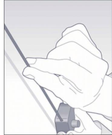
Используйте мел для разметки стен. Максимальный шаг подсистемы – 600 мм.
