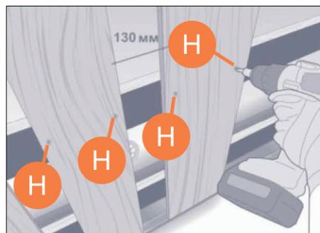
Продолжайте монтировать доски на расстоянии 130 мм друг от друга. Закрепите их с помощью саморезов или гвоздей.
