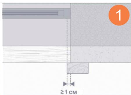
На оконных и дверных откосах бруски должны укладываться с выступом 1 см.
