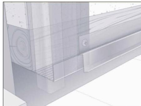
Стартовый профиль устанавливается поверх вентиляционного профиля и рядом с угловым.
