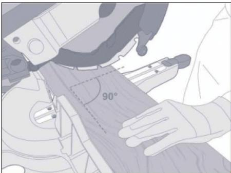
Обрежьте доску по размеру. Надевайте защитные перчатки перед резкой. При резке материала торцовочной пилой или циркулярной пилой, используйте пылесборник. доска располагается лицевой стороной вверх.
