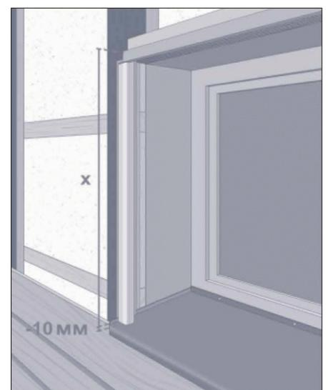
После установки отлива можно определить длину углового профиля, оставляя зазор (10 мм) для отлива.
