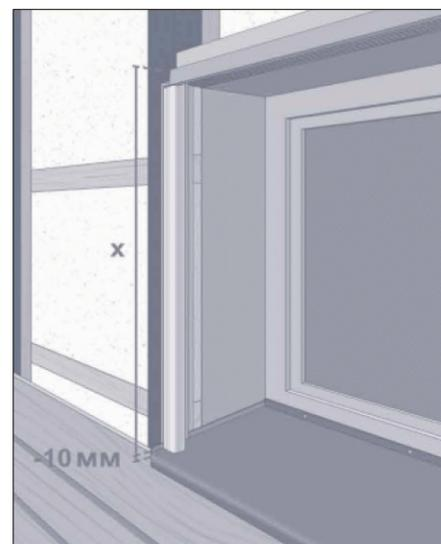
После установки отлива можно определить длину углового профиля, оставляя зазор (10 мм) для отлива.
