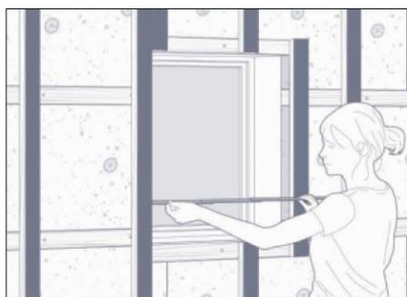
Измерьте ширину оконного проёма для заказа отливов. Отлив должен выступать, как минимум, на 40 мм за пределы фасада.
