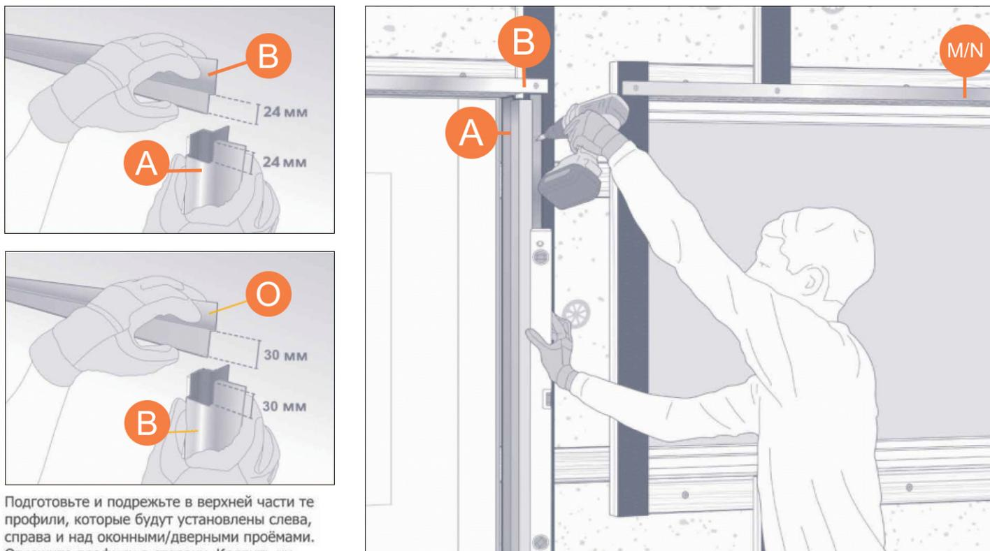
Подготовьте и подрежьте в верхней части те профили, которые будут установлены слева, справа и над оконными/дверными проёмами. Отложите профили в сторону. Крепить их будете немного позже.
