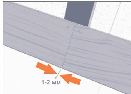
Установите следующую доску. Установка досок осуществляется с зазором 1-2 мм. Зазор 2-3 мм **ОСТАВЛЯЙТЕ КАЖДЫЕ 20 МЕТРОВ!** Торцы доски могут иметь перпендикулярное отклонения до 2 мм по ширине доски. Устраняется в процессе монтажа, торцеванием!
