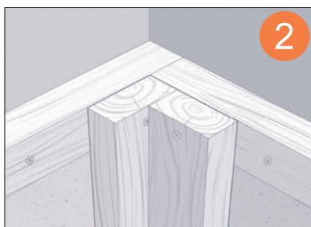
Убедитесь в том, что бруски соединяются в углах, так как они обеспечивают опору для профилей, которые будут устанавливаться позже
