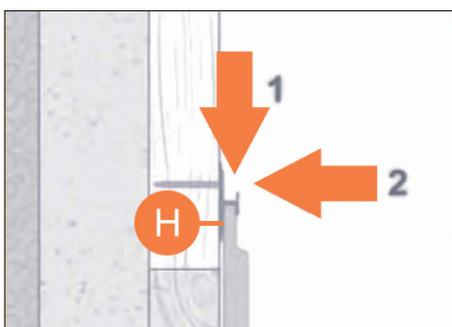
Сначала установите кляймер на доске, затем закрепите его саморезом.
