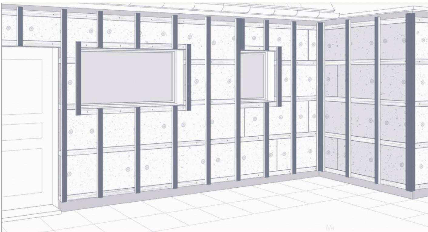
Перед установкой фиброцементного сайдинга FCS wood или FCS Click ещё раз проверьте горизонтальность стартового профиля и то, что он везде установлен на одной высоте. **Также проверьте, что потоку воздуха ничто не мешает.**
