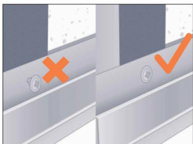
Используйте саморезы из нержавеющей стали для крепления профиля. Убедитесь, что шляпки установлены заподлицо с поверхностью профиля.
