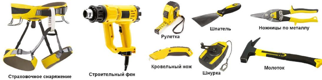
Рис. 2. Перечень инструментов монтажника
