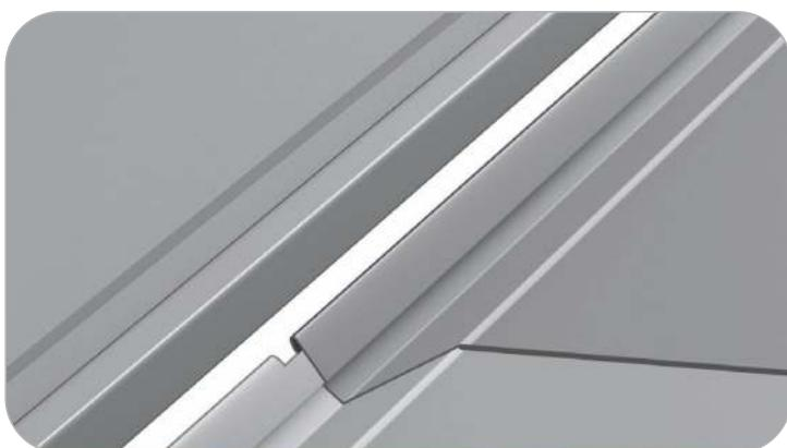
Установите следующую за описанным наращиванием панель с учетом выбранного смещения стыков. Выровняйте место стыка с помощью киянки, клещей и бруса.
