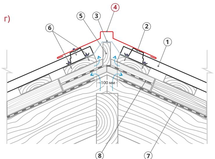
Смонтируйте вдоль конька ленту аэроэлемента. Особое внимание уделите креплению ленты на замке. Проследите, чтобы лента плотно прилегала. Можно установить брус или доску вдоль конька, через который будет натянут аэроэлемент. При такой установке вероятность протечек через коньковый узел минимальна.
