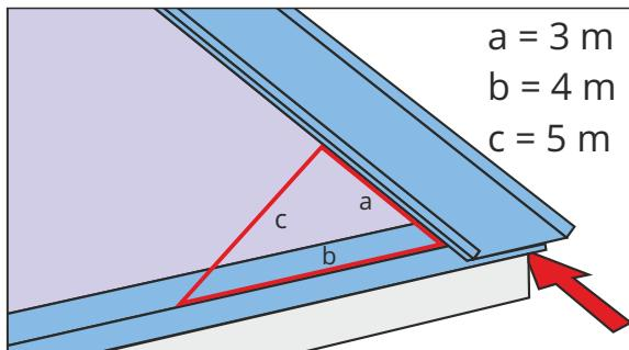
Уложите панель на скат, отступив 50 мм от края торца. Убедитесь, что панель расположена строго под углом 90° по отношению к карнизу. Для контроля прямого угла зафиксируйте панель одним саморезом в нижней точке. Отложите вдоль панели 3 м, вдоль карниза 4 м. Если гипотенуза треугольника будет равна 5 м, лист можно крепить, так как он находится точно под углом 90° к карнизной планке.
