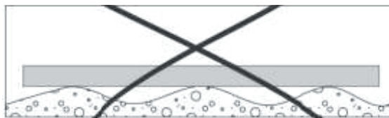
Рисунок 1. Укладка на грунт, в т.ч. и на песчано-гравийную подушку, НЕДОПУСТИМА!
